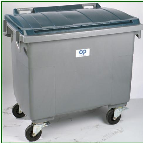
La materia prima con que están fabricados es polietileno de alta densidad de formulación especial para PLASTIC OMNIUM SISTEMAS URBANOS ,S.A., la densidad es de 0,95 gr./cm<sup>3</sup>., reuniendo las mejores condiciones de fluidez, con gran resistencia al golpe y la rotura. La fabricación es por inyección en un molde monocasco, que permite fabricar todo el
