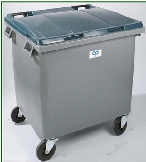
La materia prima con que están fabricados es polietileno de alta densidad de formulación especial para PLASTIC OMNIUM SISTEMAS URBANOS ,S.A., la densidad es de 0,95 gr./cm<sup>3</sup>., reuniendo las mejores condiciones de fluidez, con gran resistencia al golpe y la rotura. La fabricación es por inyección en un molde monocasco, que permite fabricar todo el cuerpo en una sola pieza, sin añadir partes remachadas a este cuerpo. Con lo
