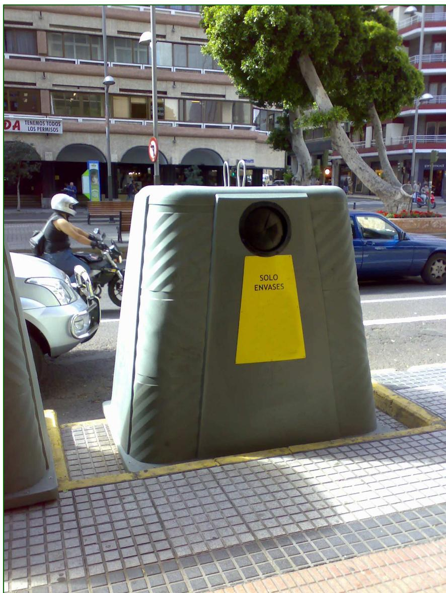
Su diseño dificulta las pintadas y pegatinas, y a la vez aporta mayor resistencia a golpes y roturas debido a la utilización del polietileno, evitando deformaciones.
