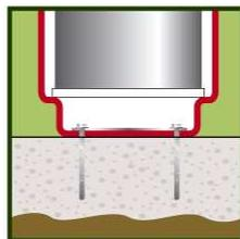
La instalación de este modelo de papelera es mediante fijación al suelo con cuatro tornillos especiales pudiéndose atornillar (con una pletina especial opcional) o cimentar al suelo.
