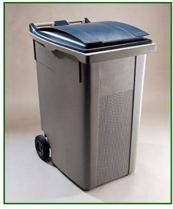
materia La prima con que están fabricados polietileno de densidad de formulación especial para PLASTIC **OMNIUM** SISTEMAS URBANOS ,S.A., la densidad es de 0,95 gr./cm3., reuniendo las mejores condiciones de fluidez, con gran resistencia al golpe y la rotura. La fabricación es por invección en un molde monocasco, que permite fabricar todo el cuerpo en una sola pieza, sin añadir partes remachadas a este cuerpo. Con
