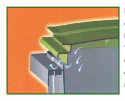
El contenedor de 360 litros está equipado con un novedoso dispositivo de insonorización de la tapa mediante "colchón de aire", que favorece la creación de una sobrepresión en el interior del cuerpo que ralentiza el cierre de la tapa y reduce las molestias sonoras.
